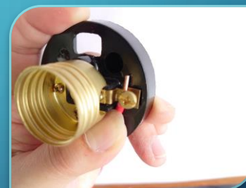
電線由燈座下方孔 洞往上穿入，銅線 壓在螺絲與鐵片間
