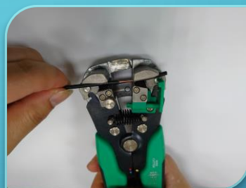
用剝線鉗將塑膠皮 (約1.2cm) 剝除
