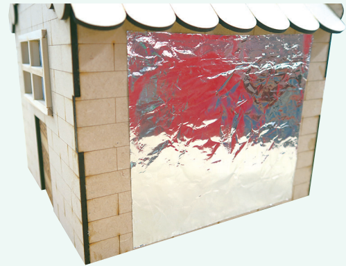
圖 4-55 鋁箔紙霧面吸熱、亮面散熱，因此可以選擇黏貼大小適當的鋁箔紙且亮面朝外
