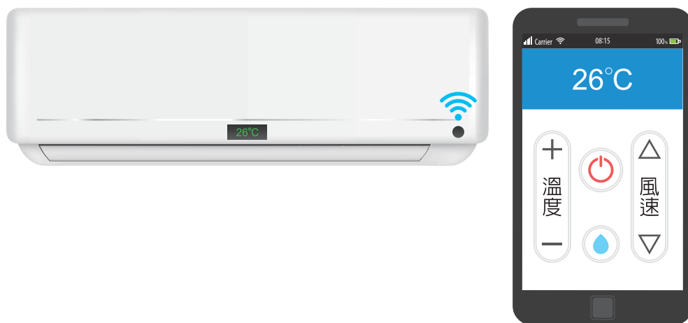
圖 4-15 冷氣機搭配物聯網智慧感測器，不僅可以遠端遙控開關機，還可設定冷氣到達指定溫度時自動運轉
