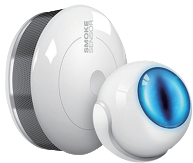
圖 4-18 動態感測器除了可偵測動態、溫度及亮度作防盜等，還有震動感測的功能，再利用物聯網連接的燈、家電等關閉，就能提高地震來襲時的安全性
